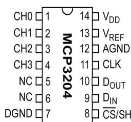
El MCP3204 de Microchip es un convertor analógico-digital de 12 bits por aproximaciones sucesivas (SAR) con interfaz SPI. Dispone de cuatro entradas que puede configurar como 4 canales single-ended ó 2 canales pseudo-diferenciales (el potencial de la entrada IN- no debe alejarse más de unos 100mV del potencial de GND). La referencia de tensión debe ser externa, funciona a 3 ó 5V y su velocidad de conversión (12 pulsos de clock) ronda las 100Ksps a 5V. Siendo un convertor de
