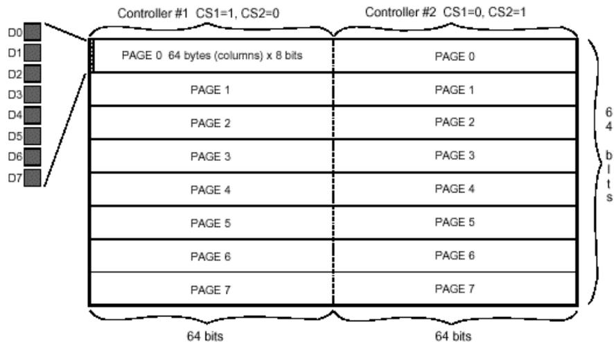
El direccionamiento del byte a leer o escribir en memoria se hace mediante comandos, como en los displays alfanuméricos, pero aquí tenemos dos direccionamientos: vertical y horizontal, y por lo tanto dos comandos :
