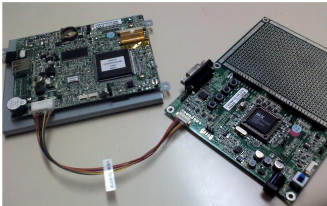
Se incluye además el código fuente y una utilidad para cargarlo en la placa, de modo que el usuario pueda cargar una demo para su propio producto. La placa se conecta con una PC mediante un puerto serie asincrónico RS-232
