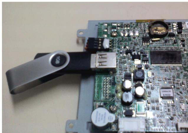
A continuación, alimentaremos el display con el jumper puesto. El LED rojo comenzará a parpadear y luego de un tiempo dependiente del tamaño de la imagen binaria (de segundos a minutos), sonará el buzzer y se dará por terminada la operación.
