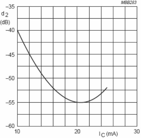
$V_{CE} = 10 \text{ V}$ ;  $V_O = 60 \text{ mV}$ ;  $f_p + f_q - f_r = 810 \text{ MHz}$ ;  $T_{amb} = 25^\circ\text{C}$ .
